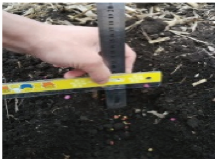
图 8 种肥深度间距测试 Fig. 8 Depth of seed fertilizer depth test
