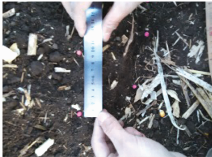
图 4 播种均匀性测试 Fig. 4 Seeding uniformity test
