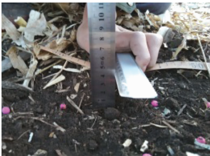
图 5 种子深度测试 Fig. 5 Seed depth test pattern
