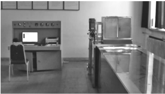
图4 JPS-12 排种器试验台
