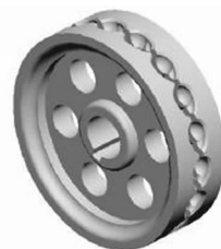
图3 排种窝眼轮型孔结构
