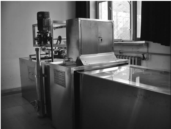
图 6 JPS-12 计算机视觉精密排种器性能检测试验台 Fig.6 JPS-12 computer vision precision metering test-bed
