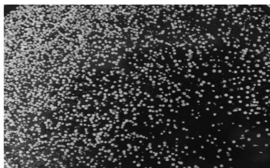
图 2 壳聚糖微球的显微镜图
