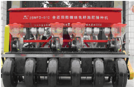
图1 2BMFD-6/12 型全还田防缠绕免耕施肥大豆播种机
