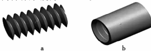
a. 右螺旋单螺杆; b. 左螺旋螺旋机筒。
