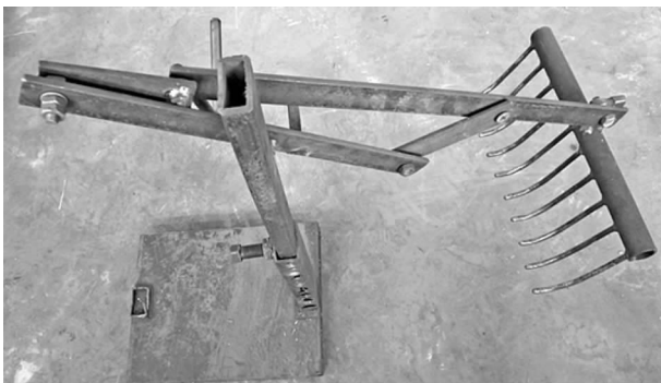
图 5 自制捞取机构试验装置
