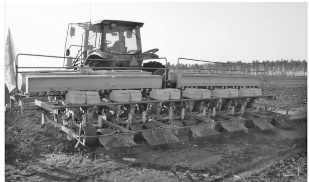
图4 2BJQ-6 型气吸式精量播种机 Fig. 4 2BJQ-6 vacuum precision seeder
